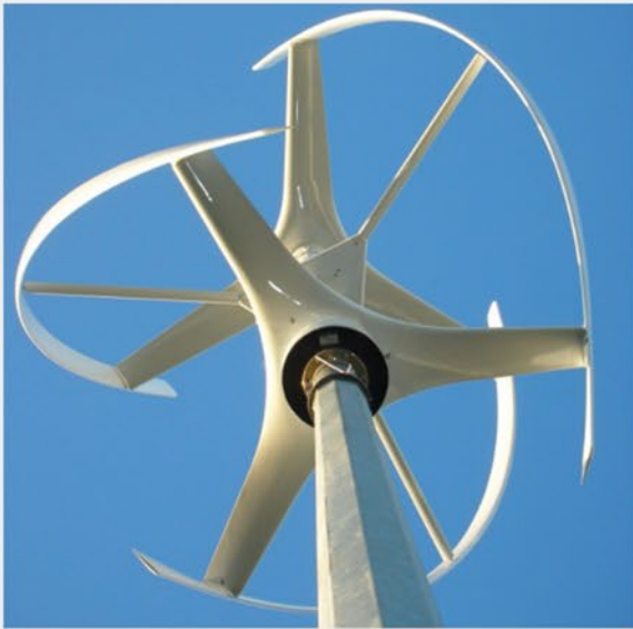
توربین‌های بادی محور عمودی با ساختار پره‌های چرخان
