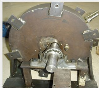
ساختمان موتور پیستونی-دورانی موسوی زاده این موتور از یک بدنه و یک چرخنده درست شده است
