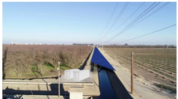
شکل ۷: نحوه قرارگیری پنل‌های خورشیدی بر روی کانال خروجی.
