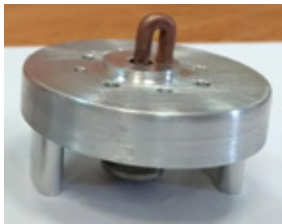
شکل ۱: راست: تعبیه پورت‌های نمونه‌گیر بر روی بدنه کاواک، چپ: آنتن نمونه‌گیر.
