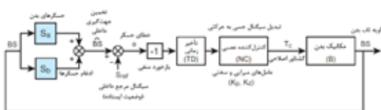
شکل ۱۶: بلوک دیاگرام کنترل بازخورد تعادل بدن.
